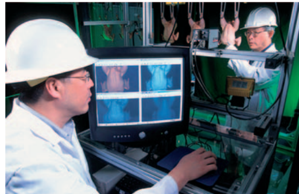
Slika FOp02 – Primjena strojnoga vida u detekciji fizikalne i ine kontaminacije
