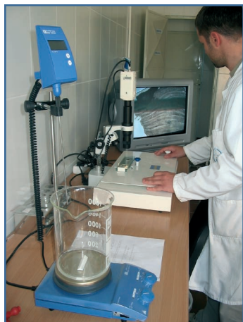
Suvremeni uređaj za izvođenje umjetne probave
